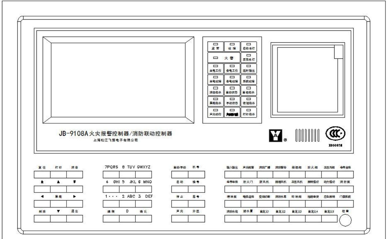
(图 1) JB-9108AB 型控制器主面板、操作键盘
