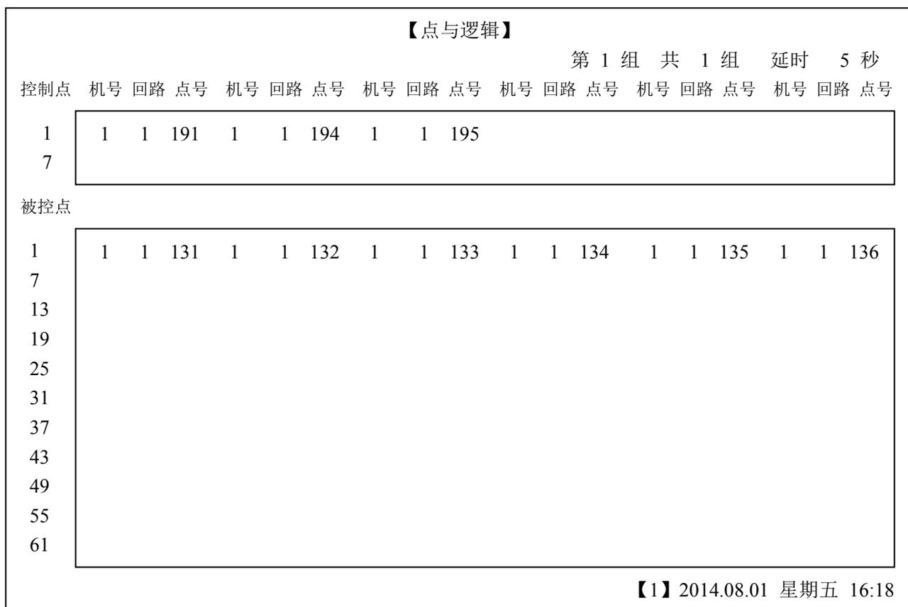
附图说明：点与逻辑方式下，当控制点中的 3 个点都报警时，将启动被控点中的 6 个模块，延时为 5 秒，延时小于 5 秒，按 5 秒处理
