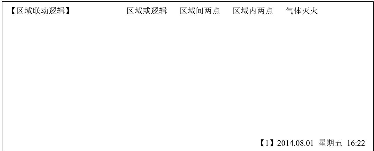
附图说明：分区逻辑分为 4 个逻辑方式，区域或逻辑、区域间两点、区域内两点、气体灭火，以区域或逻辑为例，按下确认键，在 LCD 显示屏上显示下面菜单：
