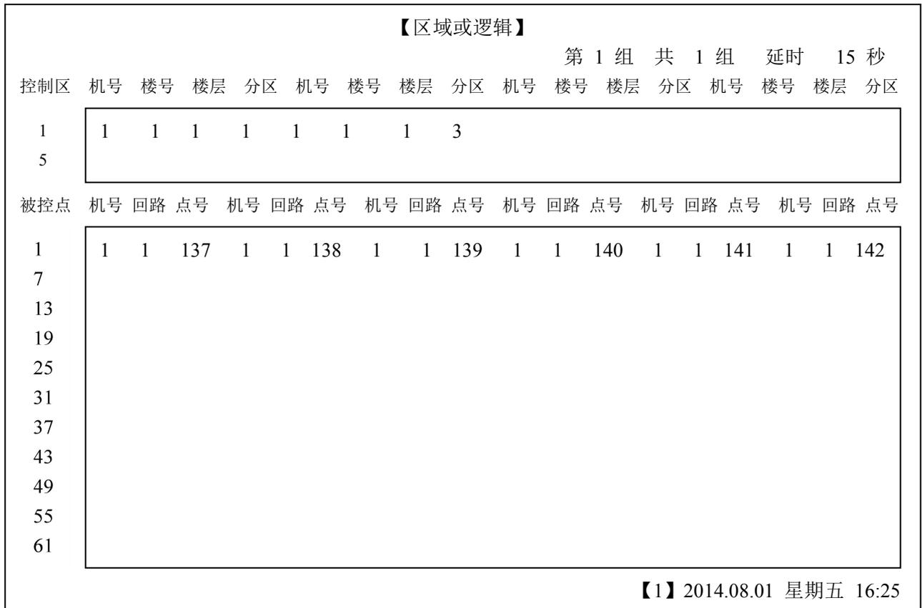
附图说明：点与逻辑方式下，当分区内任意一点报警，将启动被控点中的 6 个模块，延时为 15 秒。
