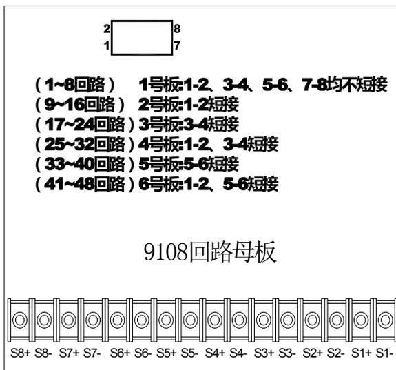
⚠ 接联网通讯用RVS线(双绞线), 线径不小于1.5平方毫米。
