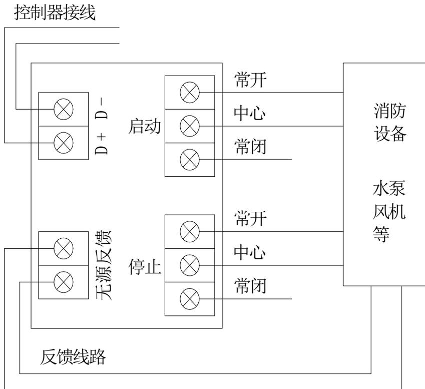
说明：直接启动装置的启动和停止端，都有常开常闭触点，电流约为 DC/AC 3A，可根据现场实际情况使用。
