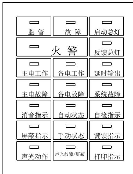
(图 2) 控制器的系统状态显示屏
